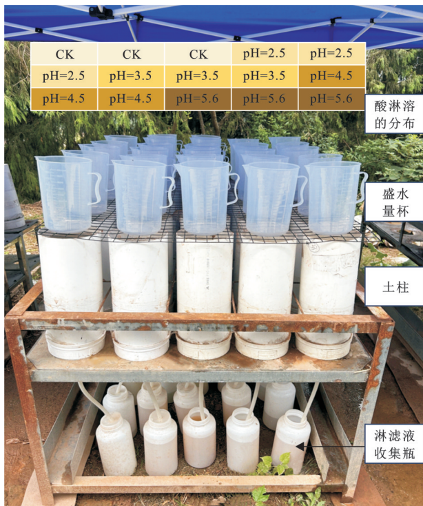
图 1 土柱试验现场装置图
