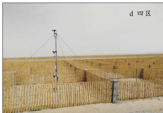
图 4 现场风沙监测仪器布设场景
