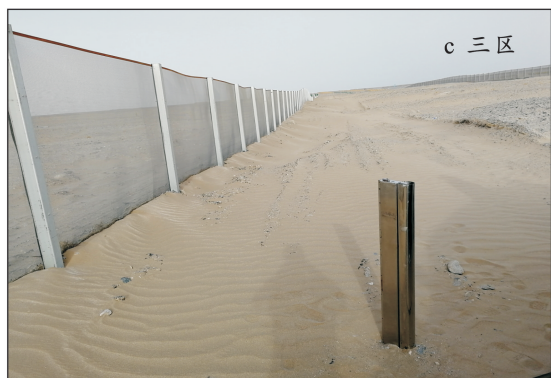
图 4 现场风沙监测仪器布设场景
